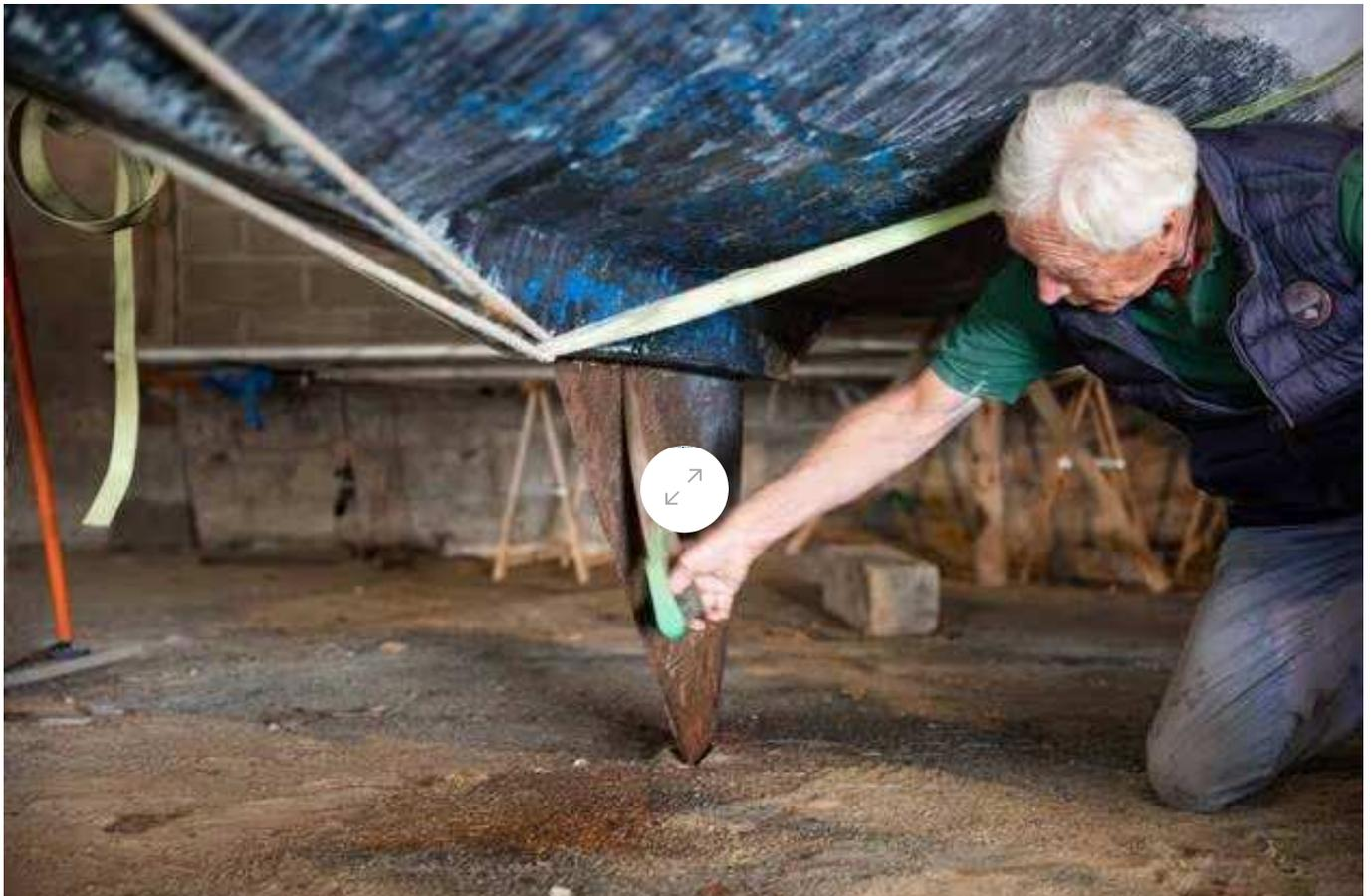
À l'aide d'une scie à bois, Philippe découpe la rouille des dérives pour les remettre en mouvement. | THIBAUD VAERMAN
